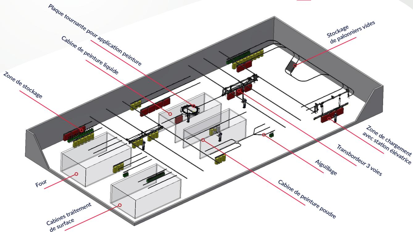
**Télesto est un système de manutention aérienne manuel ou automatisé.** Il est principalement destiné aux industries de traitement de surface et peinture pour transporter et stocker des **charges allant jusqu'à 1 tonne.**
