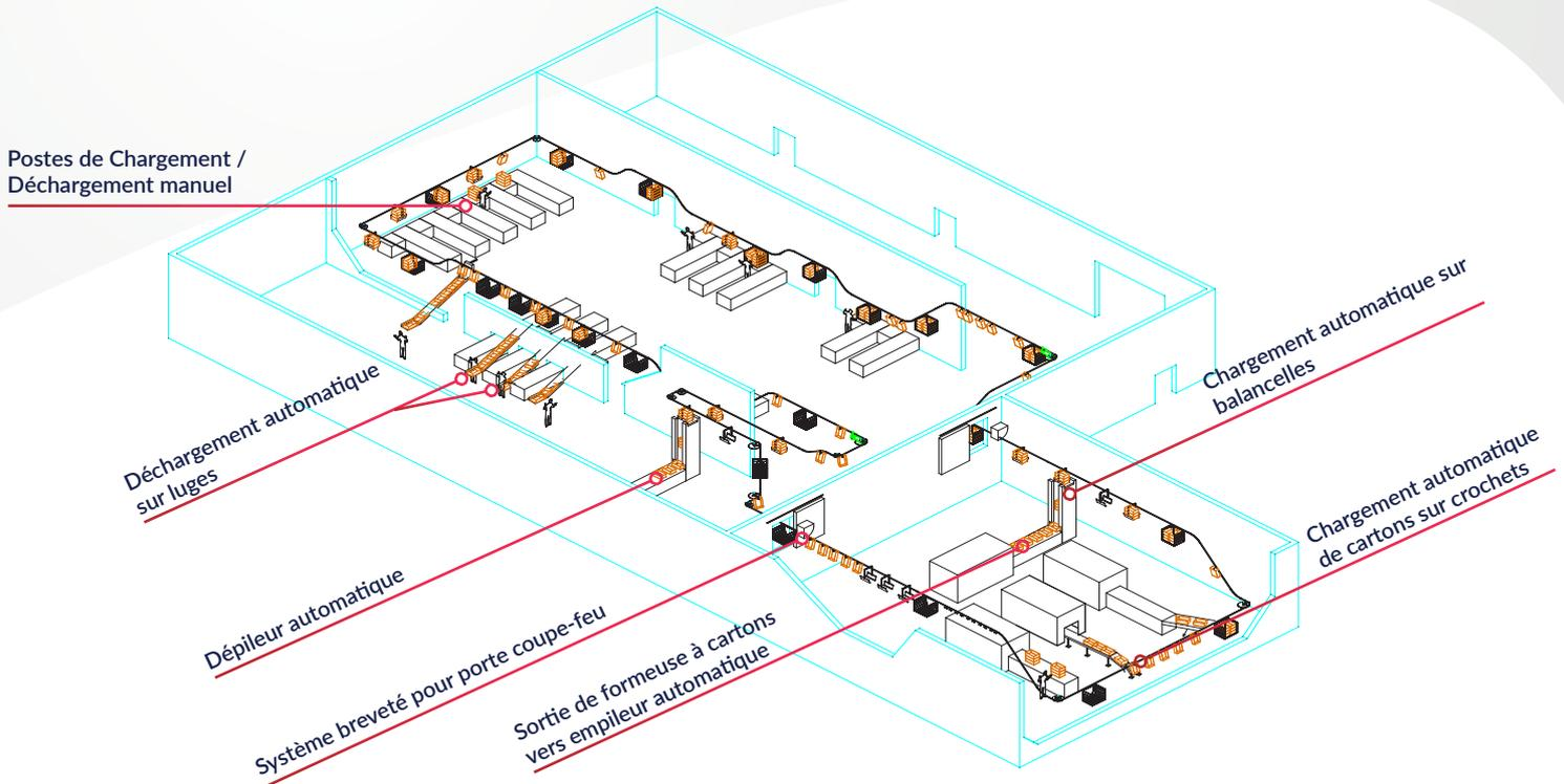
**Orion est un convoyeur à corde.** Il s'agit d'un système de manutention aérienne simple, propre et silencieux, qui demande peu d'entretien.
