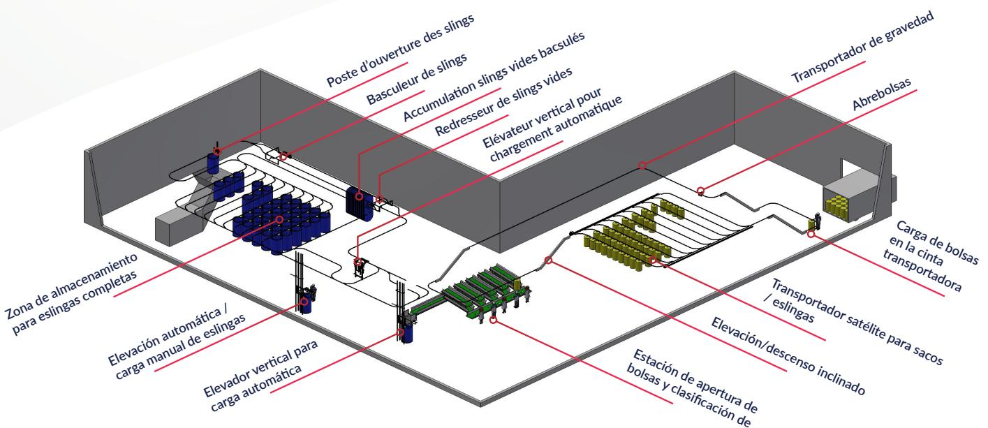
**Astron** es un transportador aéreo que se utiliza generalmente para acumular cargas unitarias (hasta 80 kg por carro) en varios tipos de industria.
