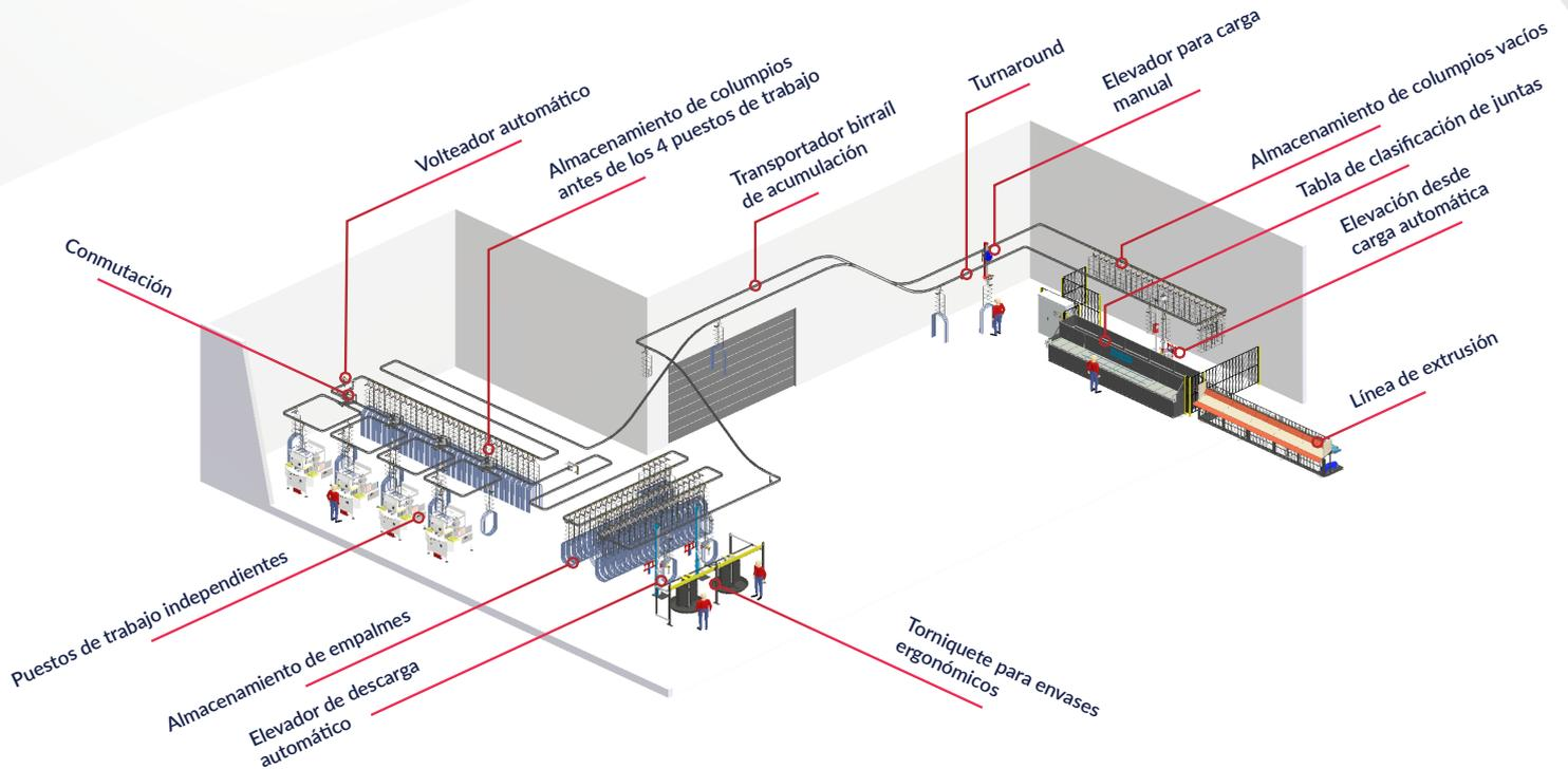
Boreal es un transportador aéreo de acumulación diseñado para transportar cargas unitarias que no superen:
