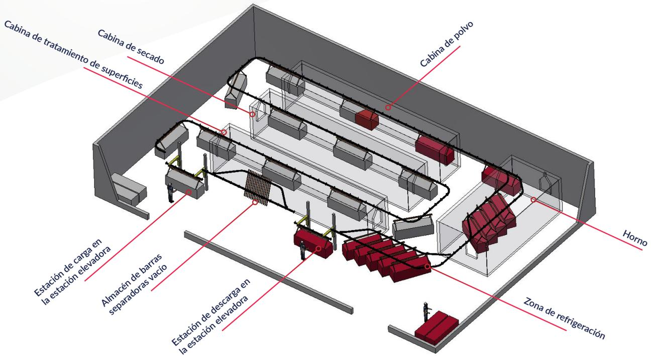
Météor es un sistema mecánico de transporte aéreo de cadena monorraíl o birraíl. **Está diseñado principalmente para transportar cargas pesadas de hasta 9 toneladas.**
