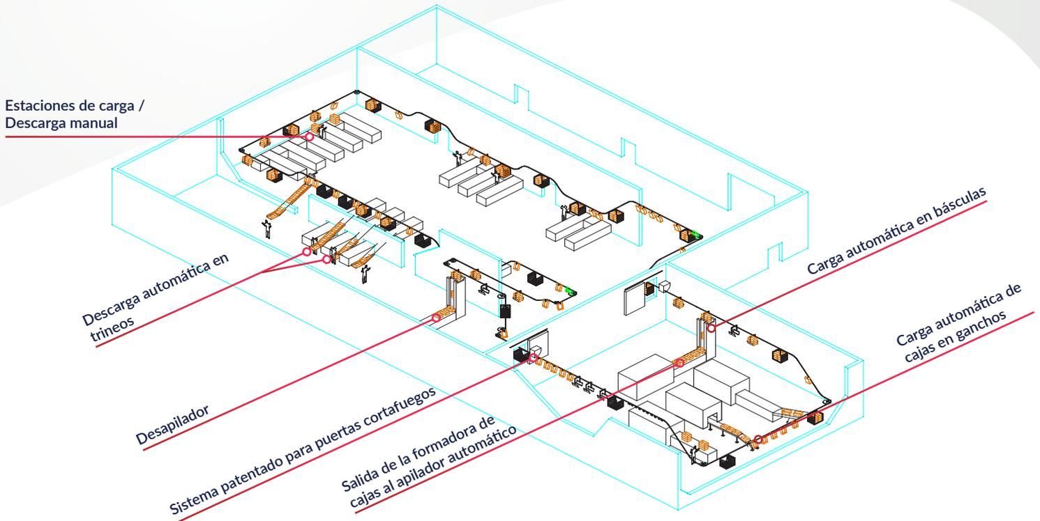
**Orion es un transportador de cuerda.** Es un sistema de manipulación en altura sencillo, limpio y silencioso que requiere muy poco mantenimiento.
