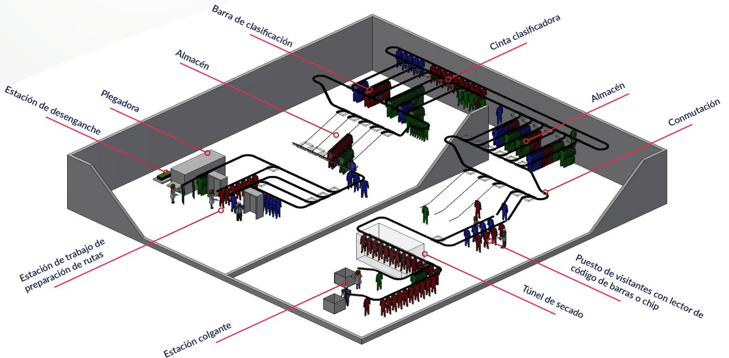
Polaris es una gama completa de transportadores aéreos diseñados principalmente para almacenar, clasificar y transportar una gran variedad de piezas: ropa, circuitos eléctricos, cubiertas, etc.
