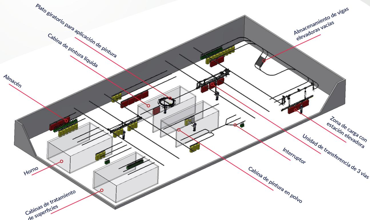
**Télesto es un sistema de manipulación aérea manual o automatizado.** Está diseñado principalmente para las industrias de tratamiento de superficies y pintura para transportar y almacenar **cargas de hasta 1 tonelada.**
